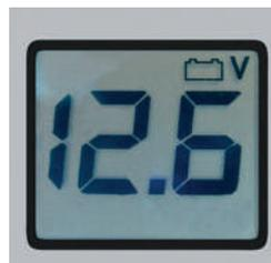
**Tension de la batterie :** Indique la tension actuelle de la batterie. La batterie 12 volts doit avoir une tension minimal de 12 volts - ou même 12,5 volts.
