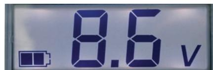
Tension d'alimentation de la pile en volts et symbole d'état de la pile
