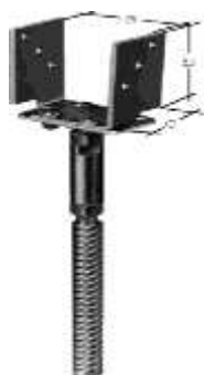
Support bichromaté réglable à sceller avec largeur réglable de 71 à 161mm et hauteur réglable (course 40mm)
