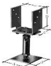
Support bichromaté réglable à cheviller avec largeur réglable de 71 à 161mm et hauteur réglable (course 60mm)
